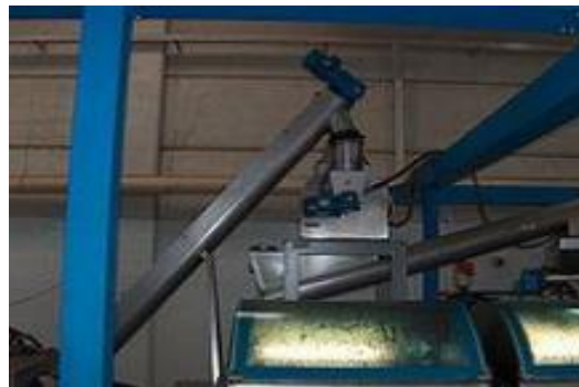
Figure II.17 : Broyeur à marteau (système moderne).
