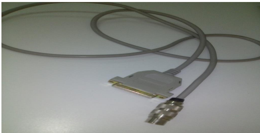
Figure IV.1 : Câble RS232 utilisé pour le transfert entre la MOCN et le PC.
