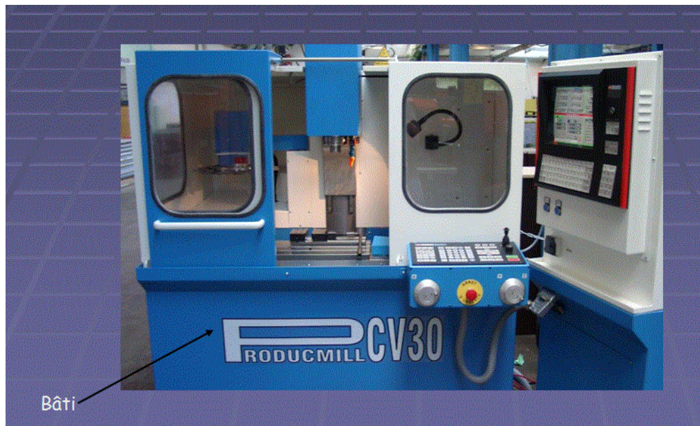
Figure I.6 : Bâti d'un MOCN [8].
