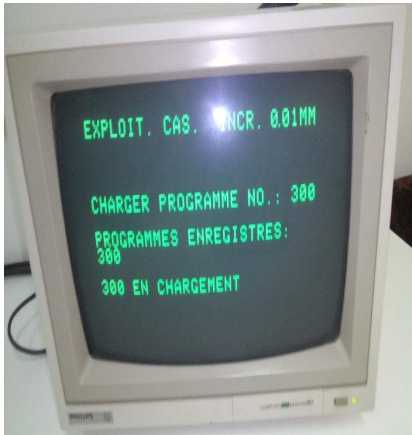
Figure IV.3 : Exemple de transfert d'un programme G-code entre la cassette et la MOCN.
