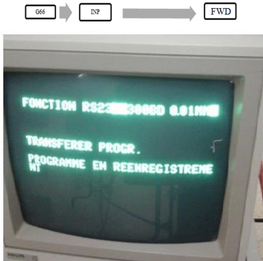
Figure IV.4 : Exemple de transfert d'un programme G-code entre la MOCN et le PC.
