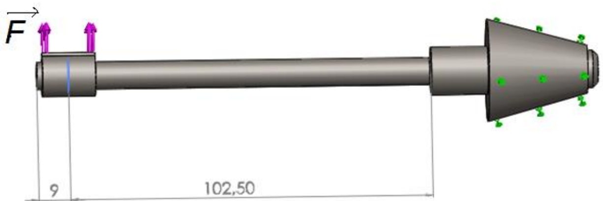
Figure 3.9. Point d'application de la charge F
