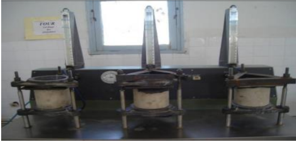
Figure III-4 : Perméabilimètre à trois cellules (Laboratoire du développement des Géomatériaux – université de Msila)
