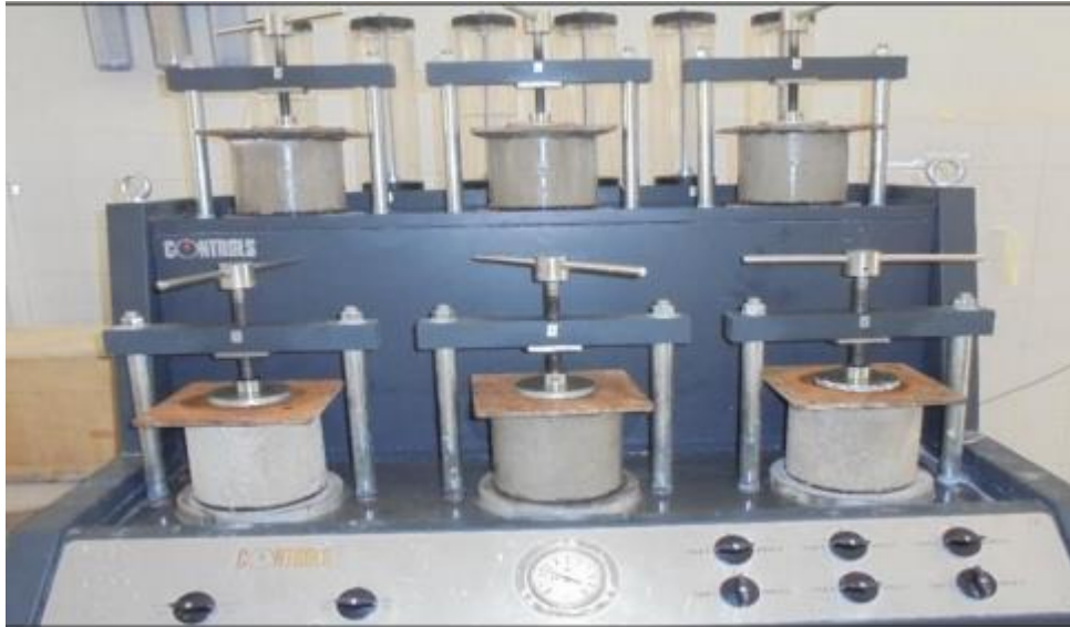
Figure III-5 : perméabilimètre permettant les tests de six éprouvettes
