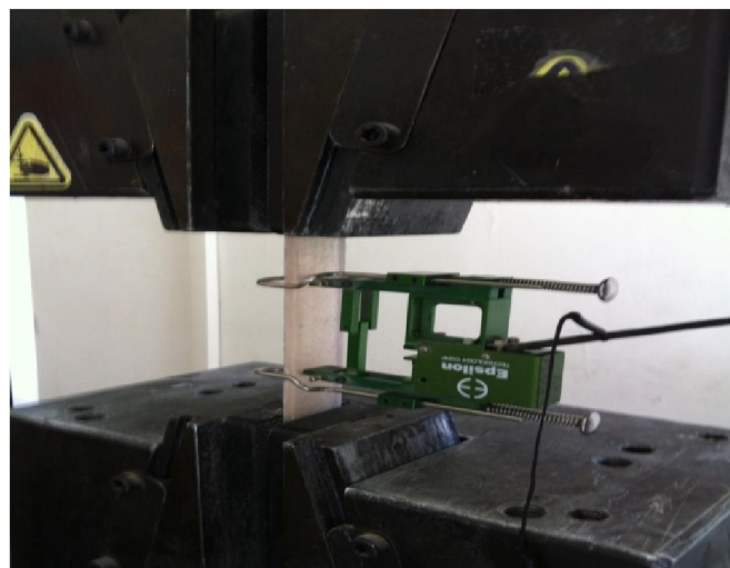
Fig.IV.12 Essai de traction sur la résine récupéré
