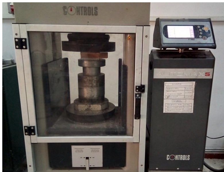
Fig.IV.14 : Essai de compression sur des éprouvettes lissées en BP.
