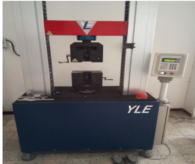
Fig.IV.11.Machine d'essais universelle électromécanique de marque YLE 20 KN
