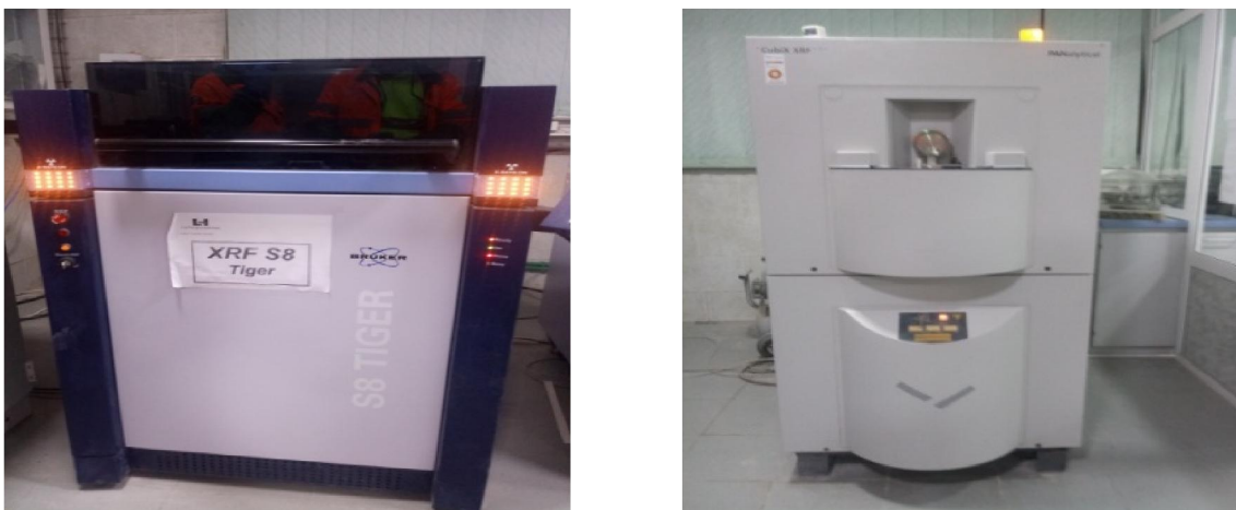
Fig.IV.6.Appareil de diffractométrie DRX (XRF S8 TIGER)
