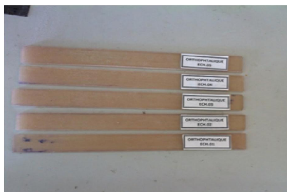
Fig.IV.10. Eprouvettes de la résine orthophthalique récupérée pour l'essai de traction
