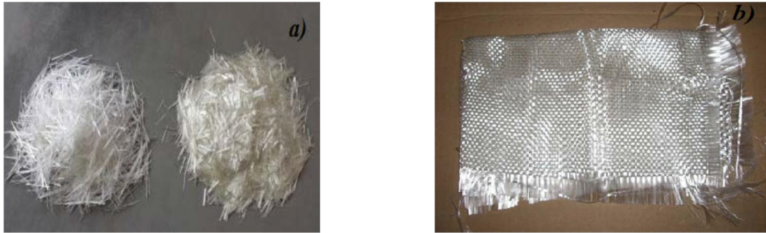
Fig.I.3. Fibre de verre (a) fibre courte et (b) tisse.
