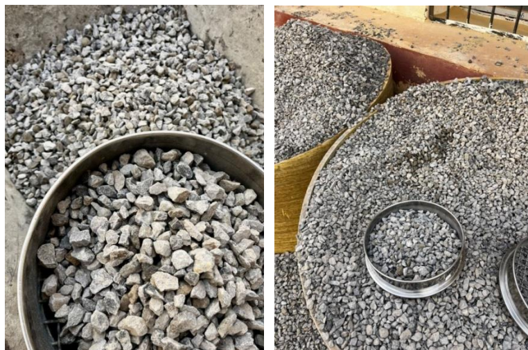
Figure II.9 : Gravillons utilisés dans l'étude : fraction 8/16 (à gauche) et fraction 3/8 (à droite)
