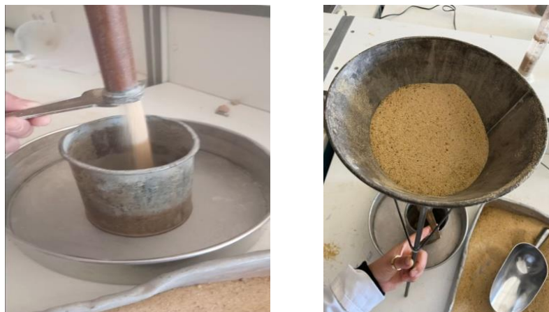
Figure II.3 : Appareil de mesure de la masse volumique apparente
