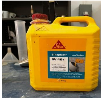
Figure II.8 Adjuvant utilisé : Sikaplast ® BV 40+
