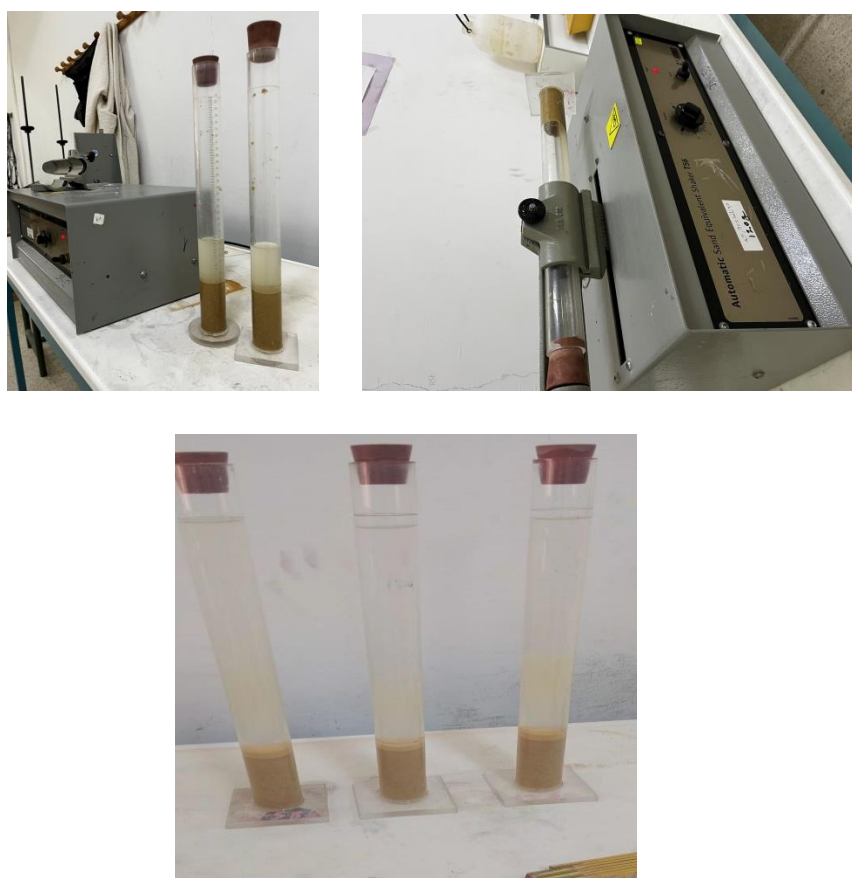
Figure II.5 : Essai d'équivalent de sable (ES) du sable propre d'Oued Souf.
