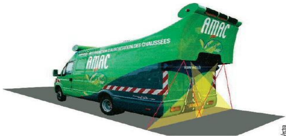
Figure-1.3 Dispositif d'acquisition d'image de surface de chaussées
