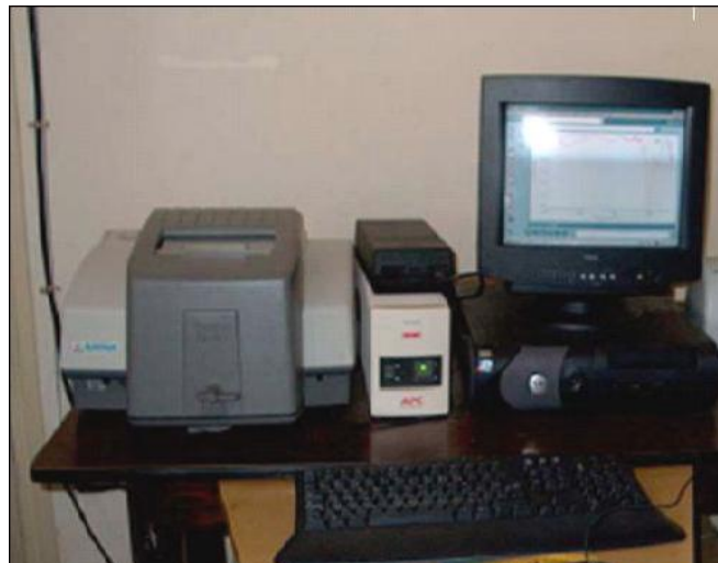
Figure II-5 : spectrophotomètre FTIR de type Thermo Nicolet Avatar 360.
