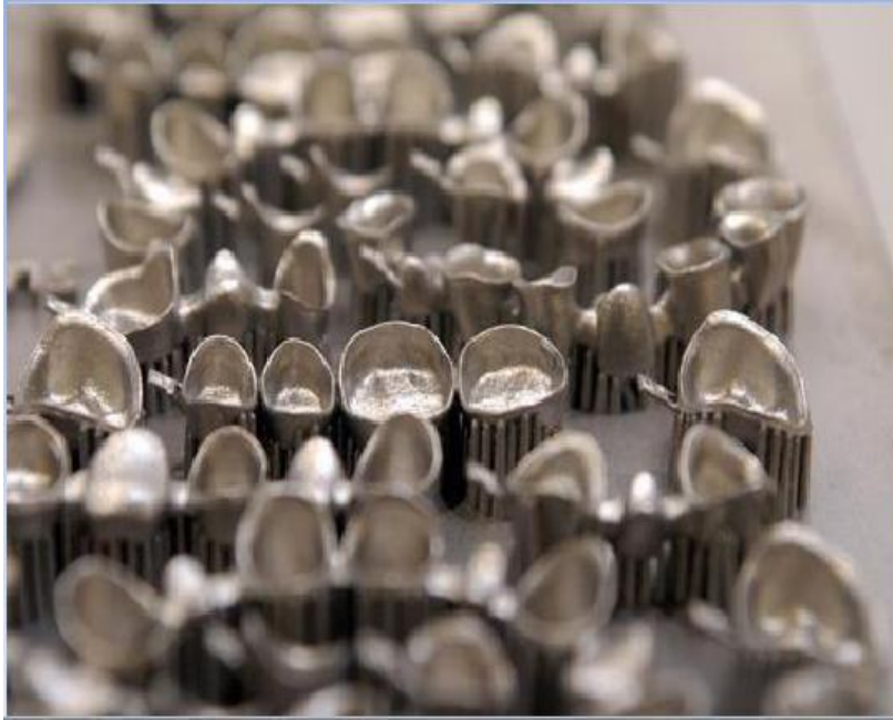
Figure IV.7 : Appareillages dentaires issus de la technologie SLS (11). Des prothèses dentaires sont réalisées grâce au procédé d'impression 3D par Frittage Laser Direct de Métal.
