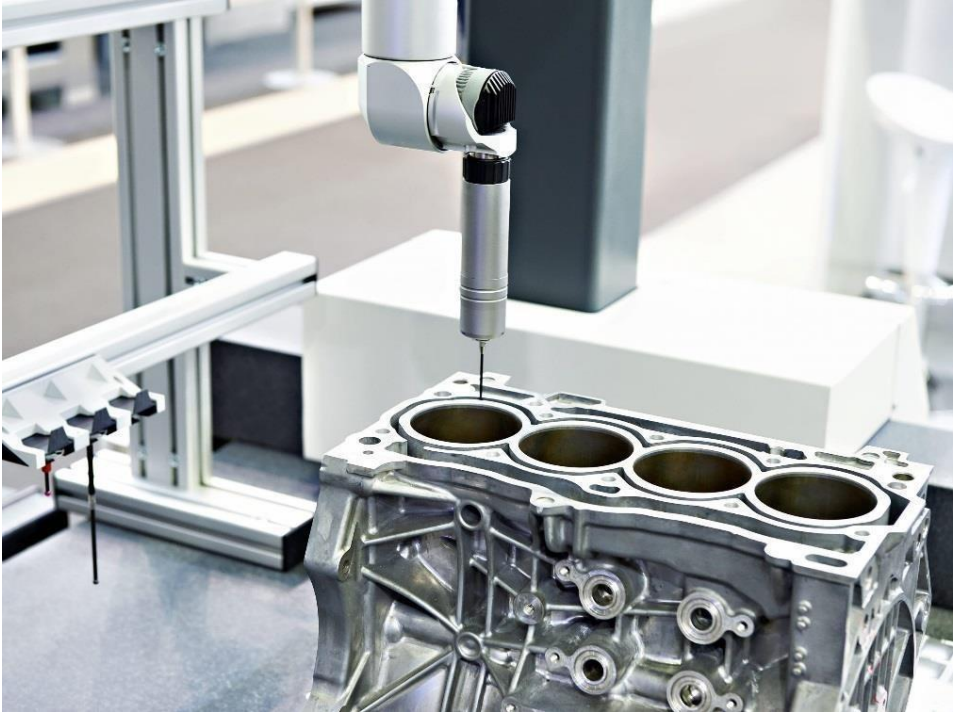
Figure 1.4. Sonde tactile à balayage de contact.
