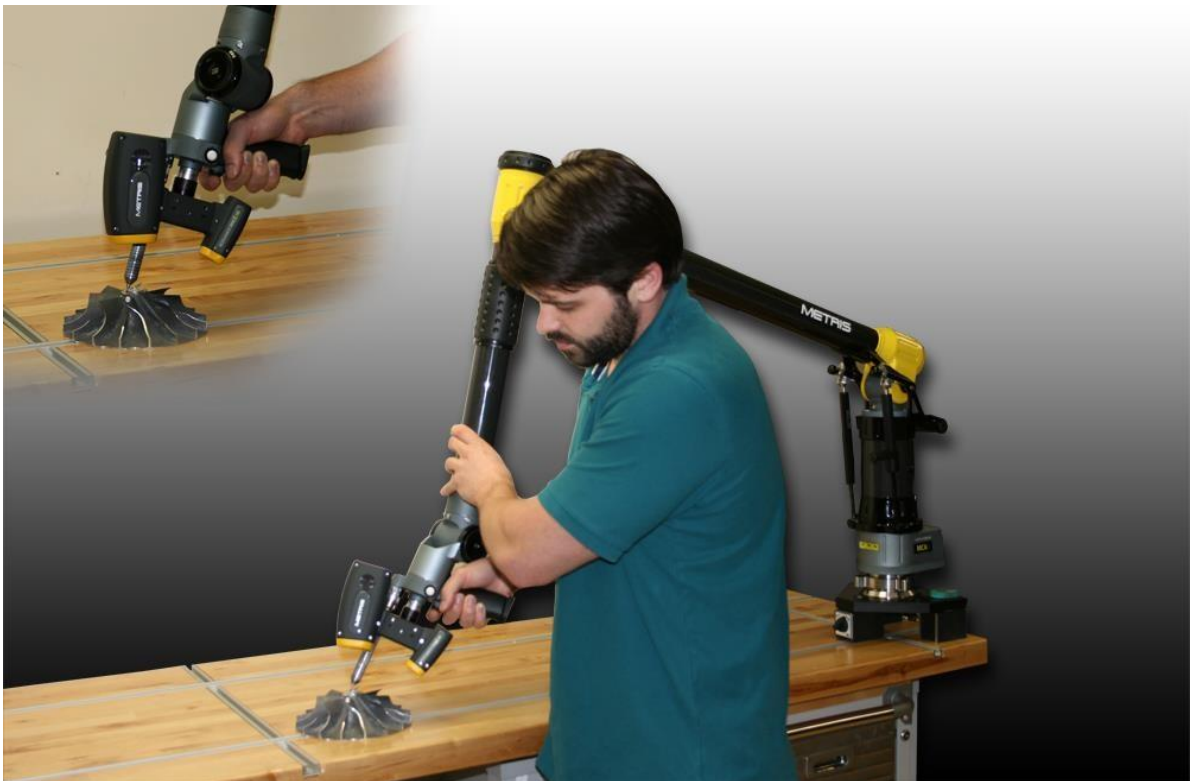
Figure III -6 Bras basé Scanner 3D et système de sondage
