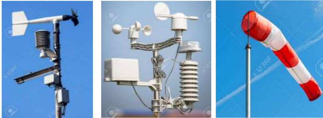
a) anémomètres à moulinet b) anémomètres à coupelle c) Manche à air
