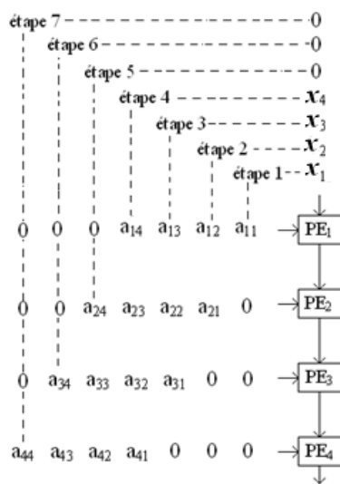
Figure III.9.a. Réseau systolique linéaire, avec vidage, pour le calcul du produit d'une matrice 4x4 par un vecteur 4x1
