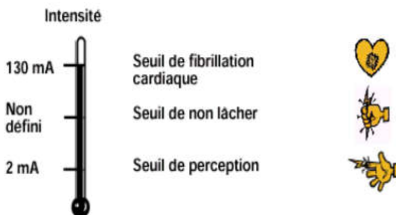
Figure II.2 : Seuils de danger du courant électrique continu
