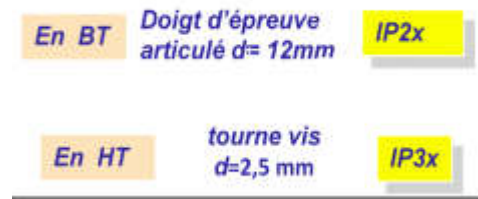
Figure III.8 : Protection contre les contacts indirects Par le choix du degré de protection
