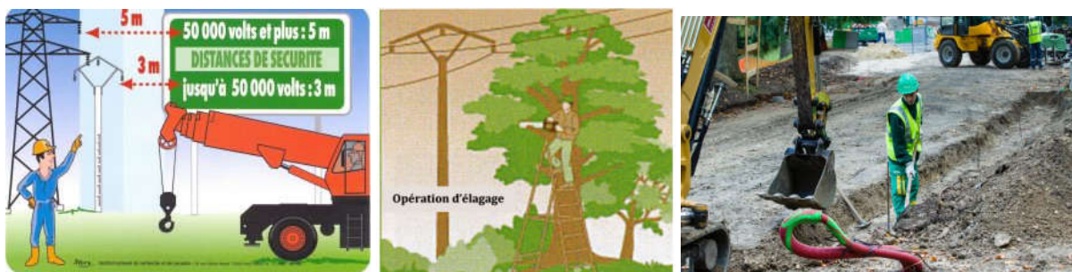
Figure.III.23 : Travaux d'ordre non électrique au voisinage de lignes électriques
