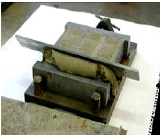
Figure III.19 : Eprouvette Prismatique de mortier ( 4x4x16) cm 3
