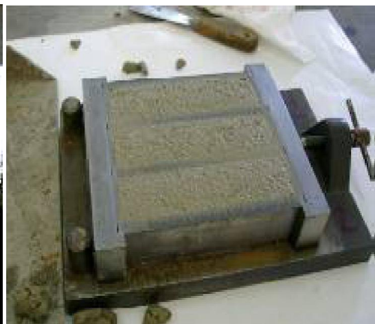
Figure III.19 : Eprouvette Prismatique de mortier ( 4x4x16) cm 3
