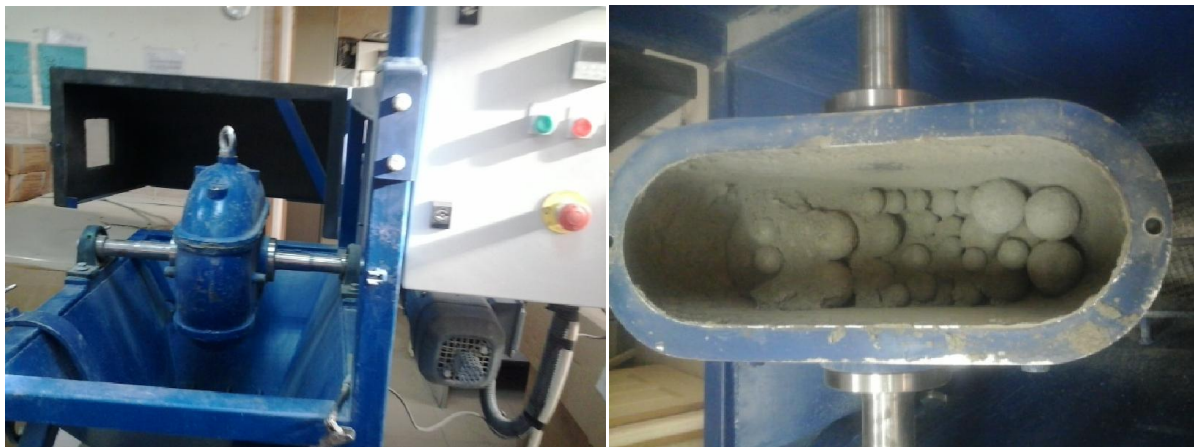
Figure III.1 ( BB10) Broyeur à Boulets
