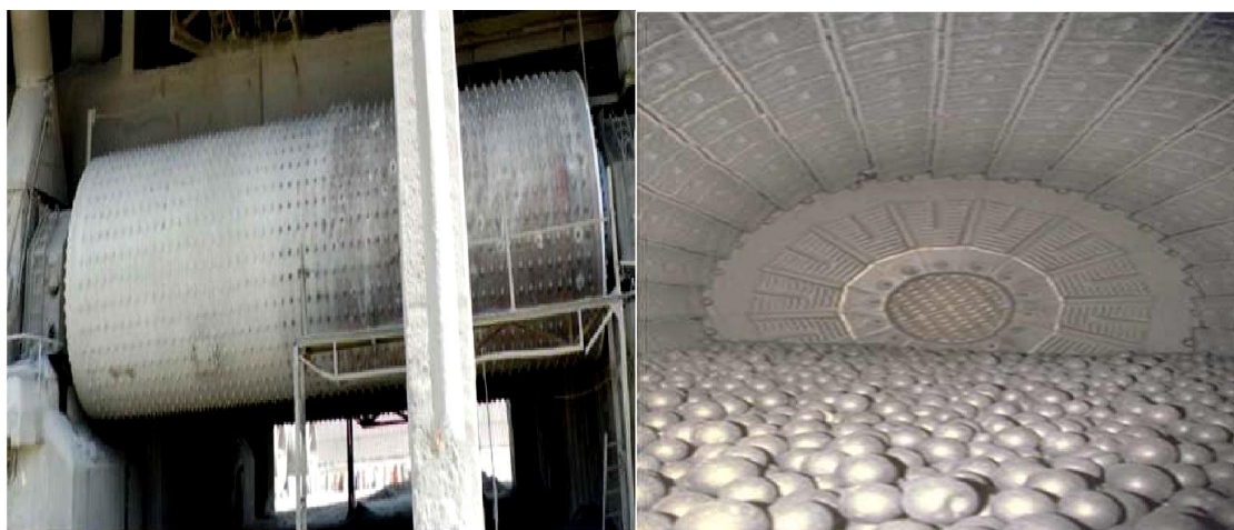
Figure I.14 : broyeurs à boulet
