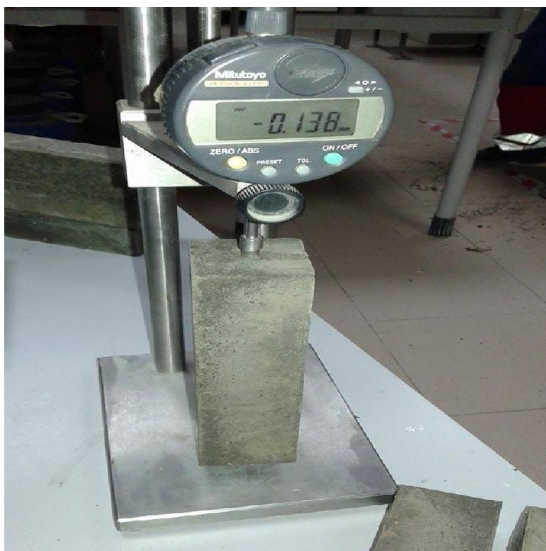
Figure III.25 éprouvette mortier 4x4x16 cm 3
