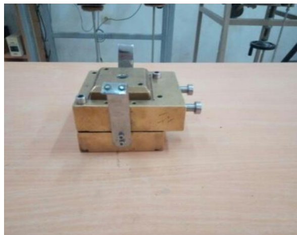
Figure II.1: Principe de la boîte de cisaillement direct
