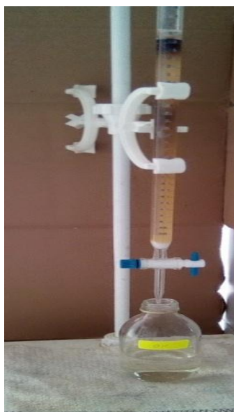
Figure02 : montage de chromatographie sur colonne
