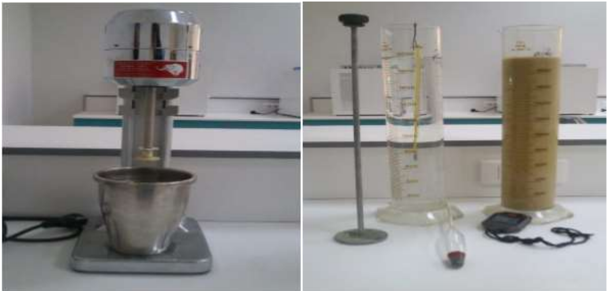
photo II-6 : Essai analyse granulométrique par sédimentométrie .[17]
