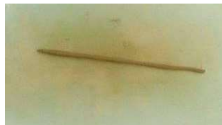
photo II-11 : limite de plasticité au rouleau
