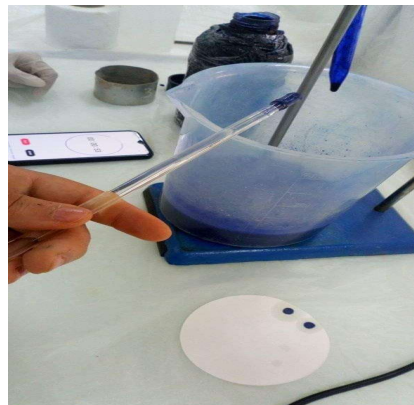
Photo II-8 : Prenez une goutte du mélange et mettez-la sur le papier filtre.
