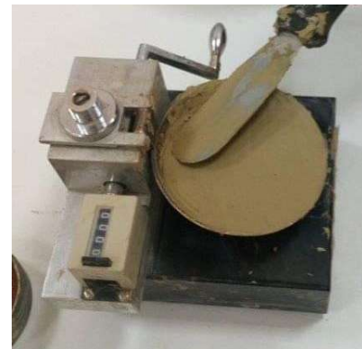
photo II-10 : limite de liquidité à la coupelle
