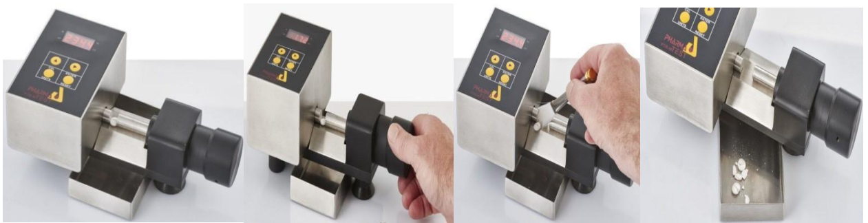
Figure 15 : Différents étapes de réalisation du test de la dureté.
