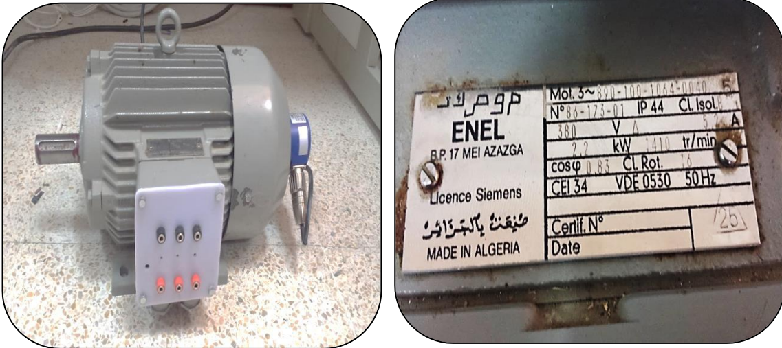
Figure II.09: le moteur asynchrone triphasé .
