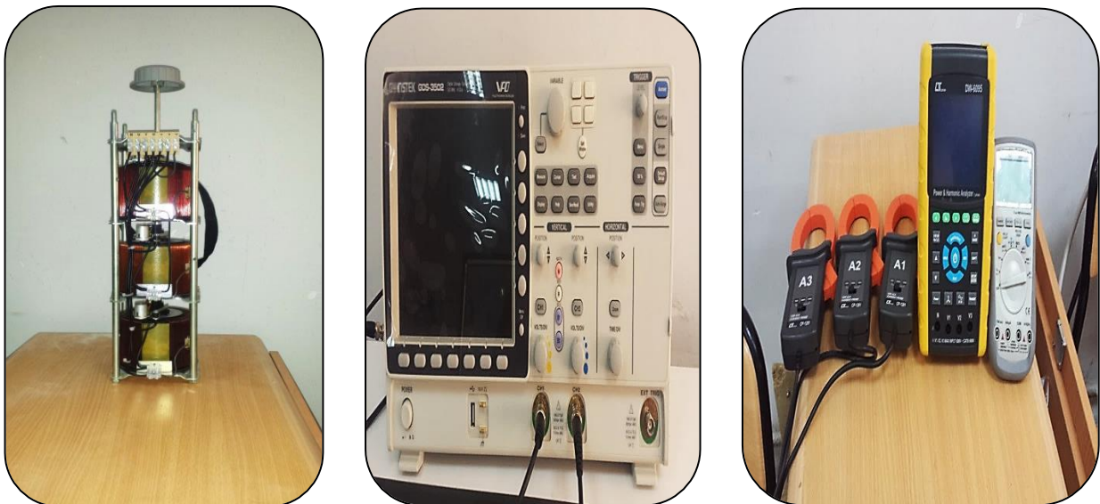
Figure II 16: Les appareils de mesures et l'autotransformateur
