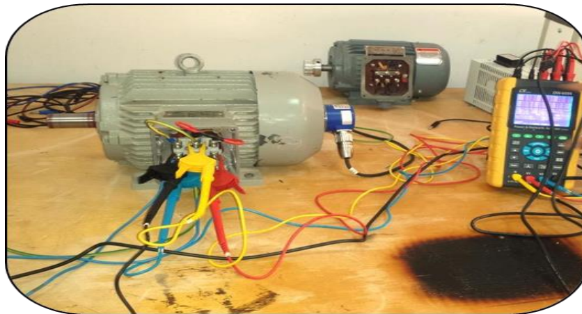
Figure (I.05): Montage pratique lors de l'essai à vide.
