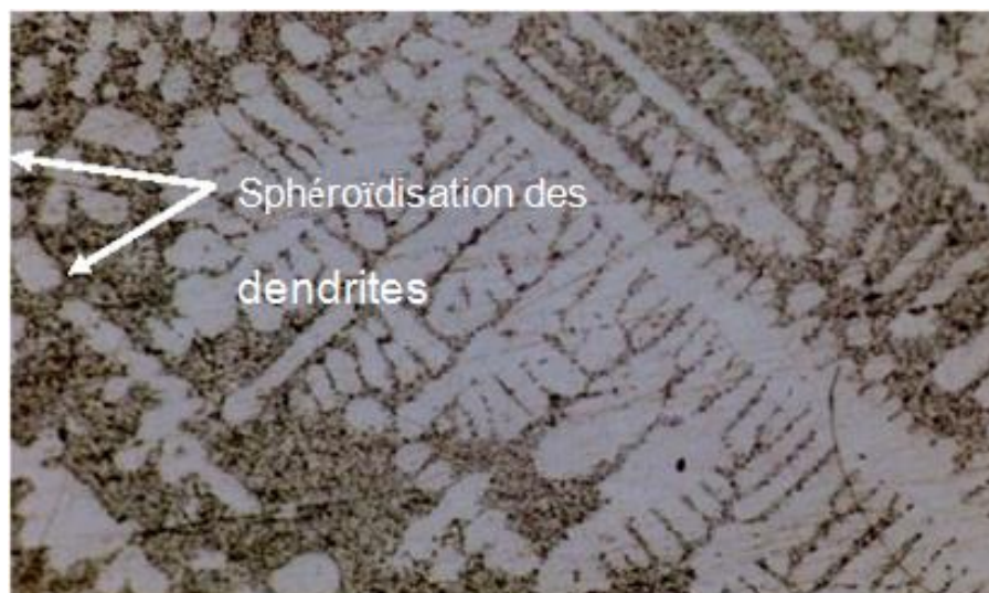
Figure IV.1: Microstructure d'un échantillon étudié après la mise en solution à 540° pendant [3h].
