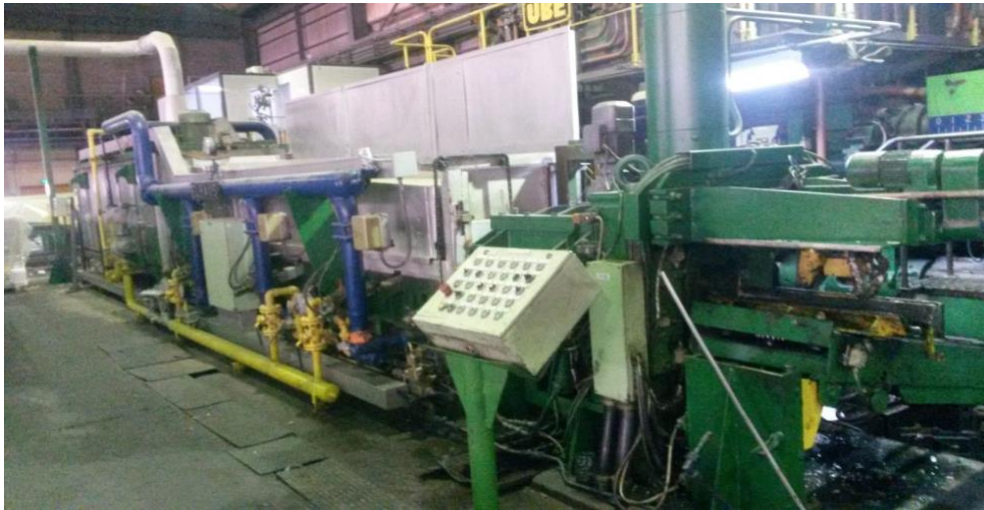
Figure III.4: Four d'extrusion utilisé pour la mise en solution.
