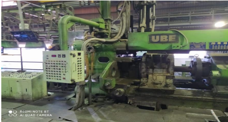
Figure III.5: Four d'extrusion utilisé pour la mise en solution.
