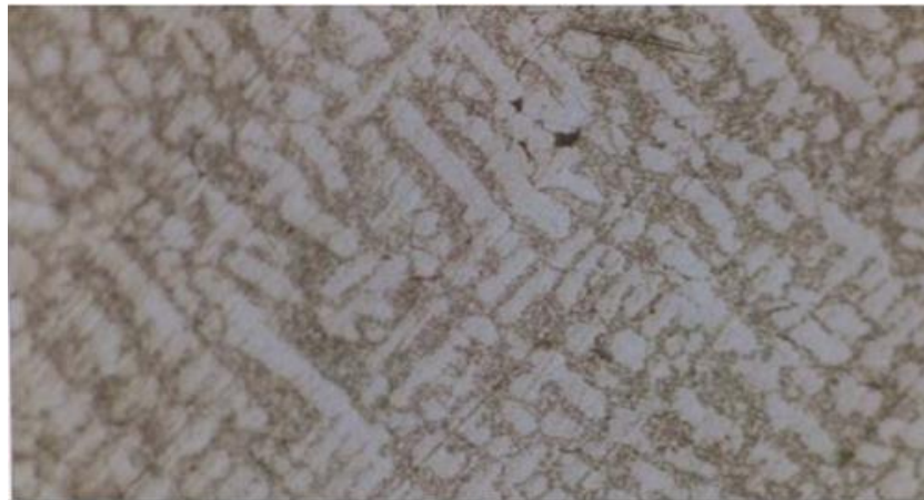
Figure IV.2 : Microstructure d'un échantillon étudié après la trempe. (X100)[47].
