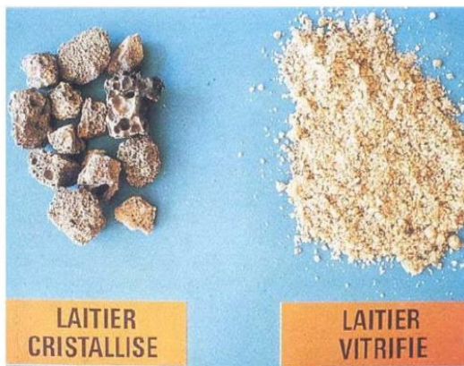
Figure II. 1 : Laitier cristallisé et laitier Vitrifié (granulé) de haut fourneau
