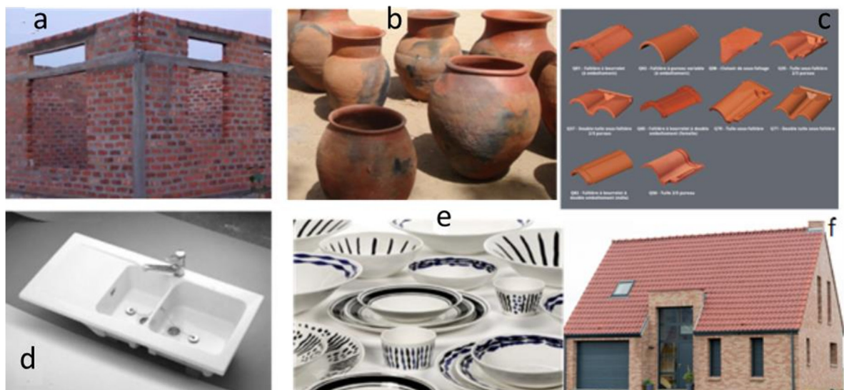
Figure II.9 : Exemples de céramiques traditionnelles : (a) mur construit en brique de terre cuite, (b) Les poteries, (c) quelques modèles de tuiles, (d) le grès, (e) les porcelaines et (f) maison construite en briques de terre cuite et le toit en tuiles. (Serewane, 2020)
