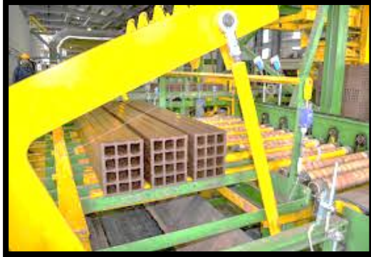
Figure I. 6 : Façonnage de la brique perforés
