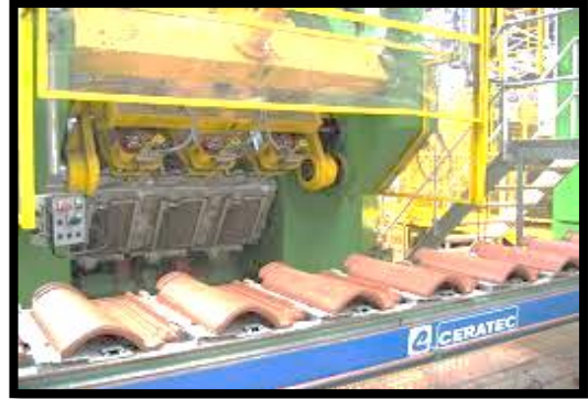
Figure I. 7 : Façonnage de tuiles
