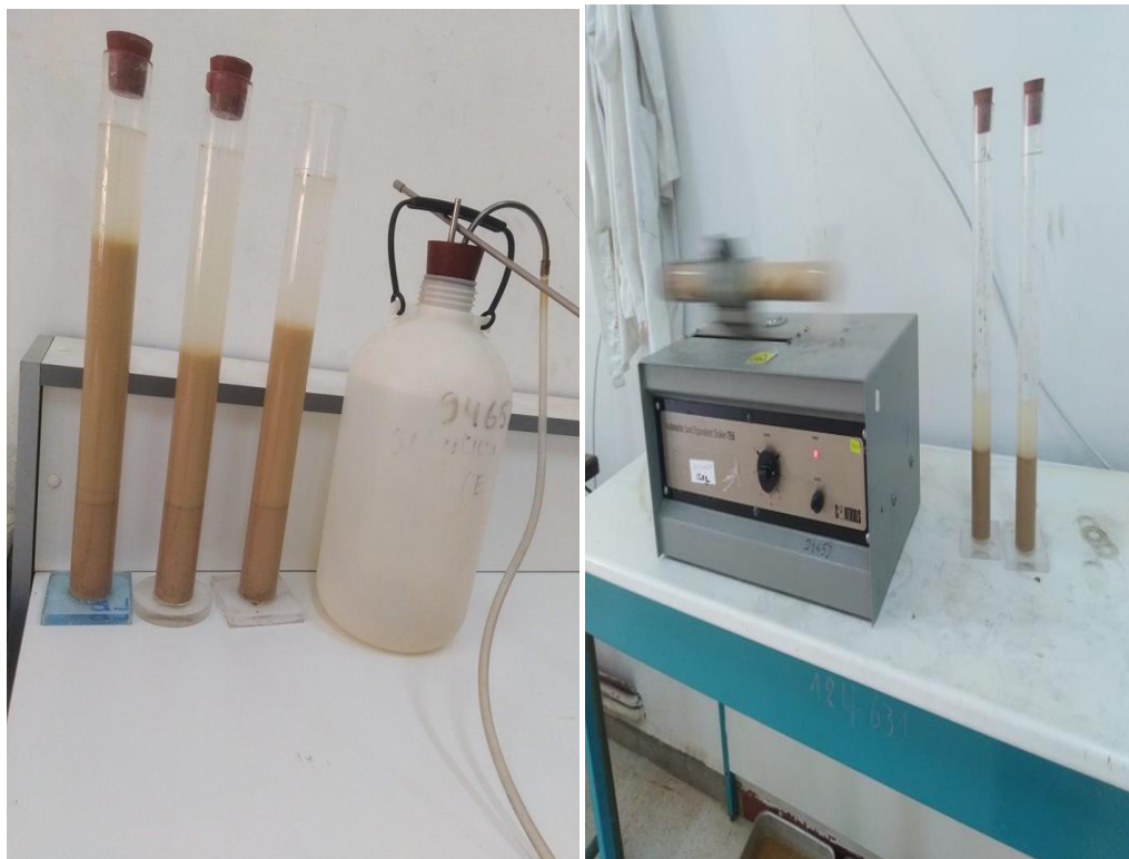
Fig. III. 6 Essai équivalent de sable visuel exécuté au laboratoire
