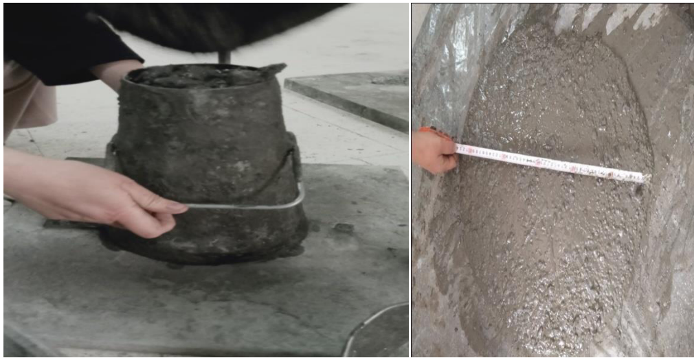
Fig. IV. 3 Exemple d'étalement d'un BAP
