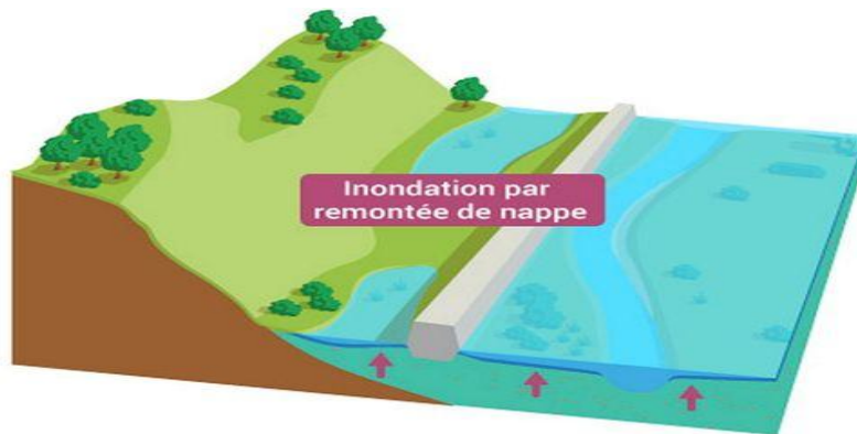
Figure 5: Inondation par remontées des nappes phréatiques
