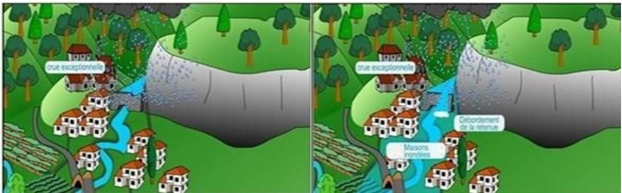
Figure 8: Inondation par débordement au-dessus de la digue
