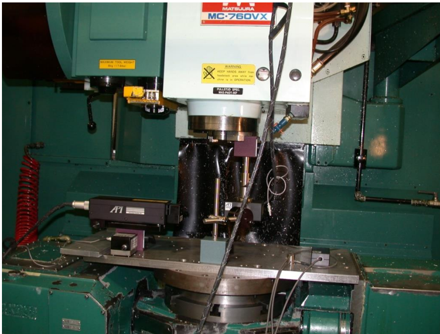
Figure III-6- Montage du laser 6 D pour mesurer suivant l'axe Y du Matsuura (vue 1)
