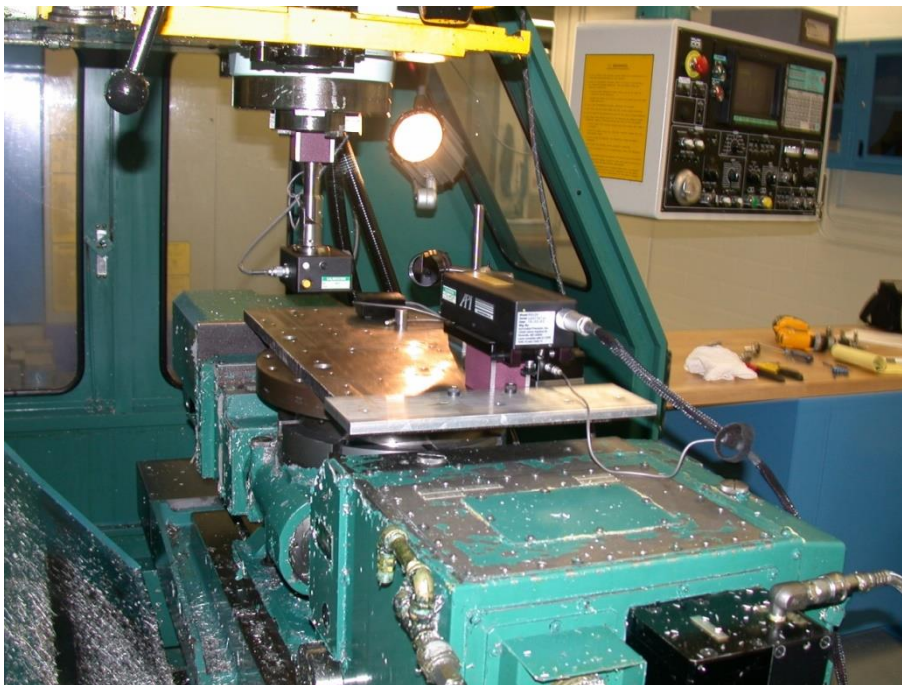
Figure III-7- Montage du laser 6 D pour mesurer suivant l'axe Y du Matsuura (vue 2)
