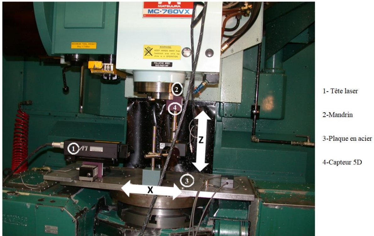
Figure III-1 - Montage pour mesurer les erreurs suivant l'axe X pour la machine-outil Matsuura MC-760 VX
