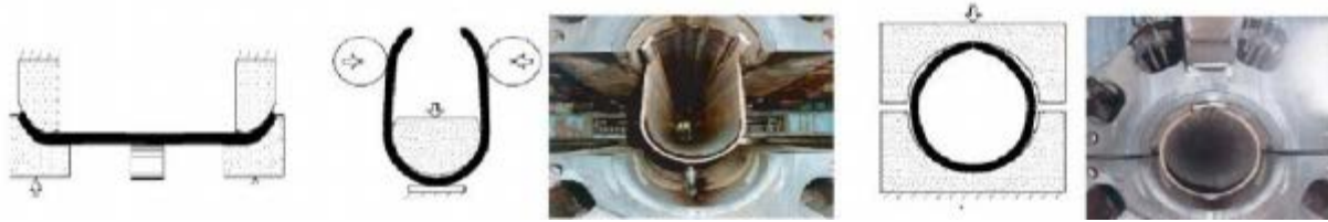
Figure I. 08: a) : Croquage b): Formage sous forme "U" c): Formage sous forme "O"
