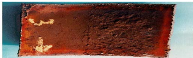
Figure II.03 : Pertes de métal dû à la corrosion interne [13].
