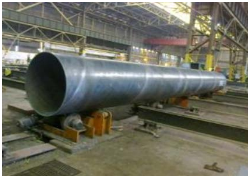
Figure I .01 : Les tubes soudés sous la forme en spirale.
