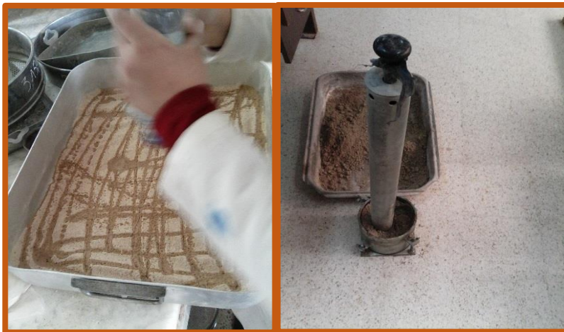
Figure (II-16): Mode opératoire(Proctor Normal)
