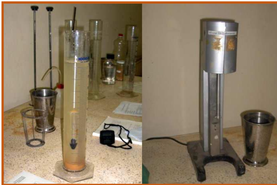
Figure (II-6) :Appareillage de sédimentométrie.
