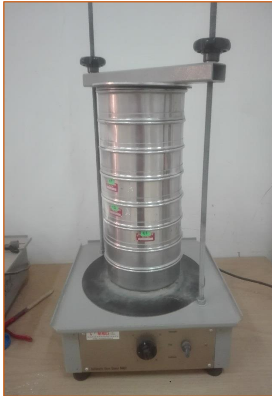
Figure (II- 5) : Une tamiseuse mécanique.
