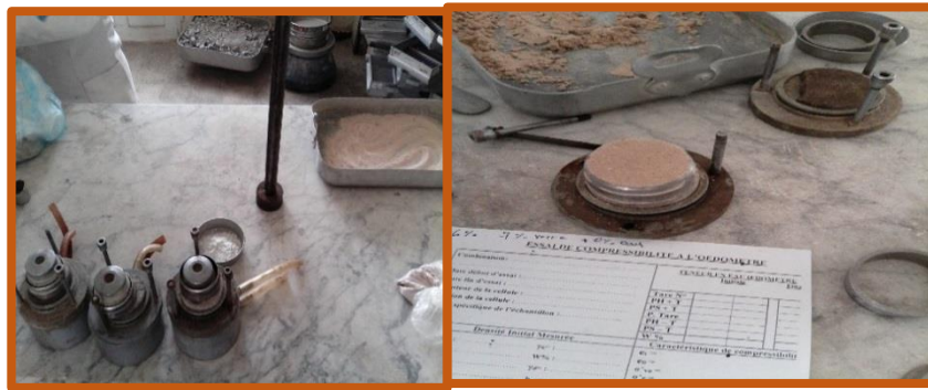
Figure (II-24) : Mode opératoire essai œdométrique
