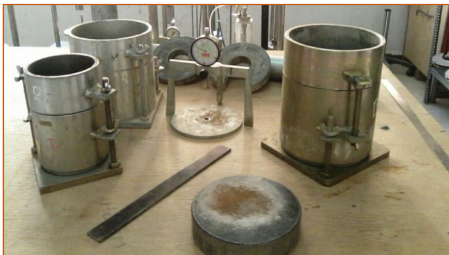
Figure (II-15) : Appareillage spécifique pour essais de compactage (Proctor Normal).
