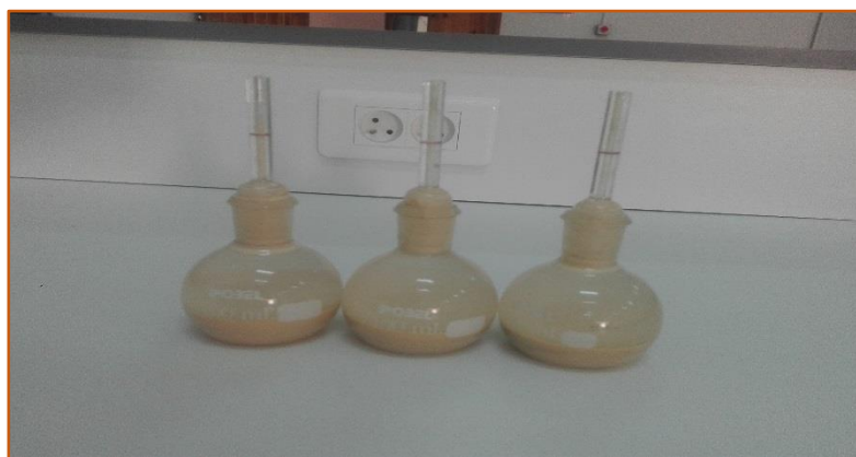
Figure (II-8) : Pycnomètre verre de 100 cm 3 .
