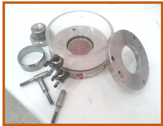
Figure (II-23) :Cellule œdométrique
