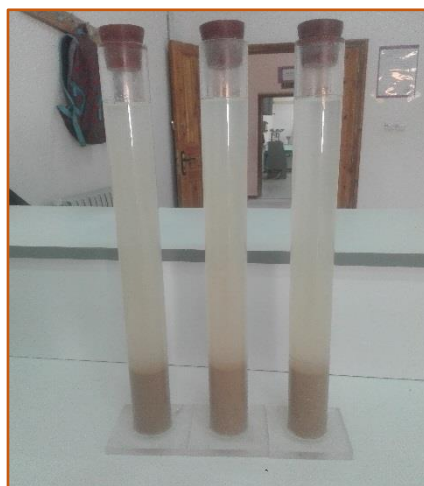
Figure (II-9) Appareillage de l'équivalent de sable.
