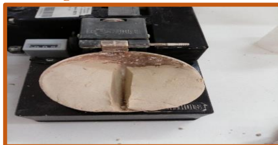
Figure (II-11) : Appareil de Casagrande et matériel de la limite de liquidité.
