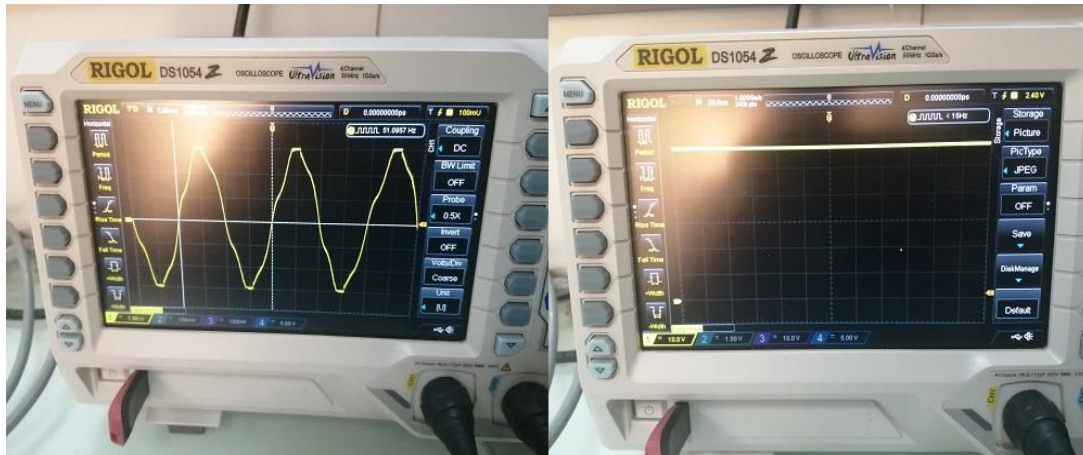
Figure. 4. 14 : Signal d'entrée du hacheur back avant et après le redressement.
