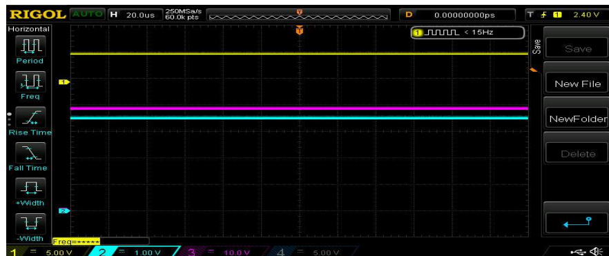
Figure 4. 22: Signaux de la tension de sortie et la commande MLI pour R = 75\Omega et V_r = 34.5V .
