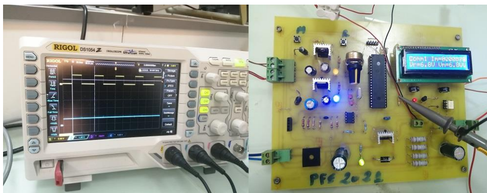
Figure. 4. 18 : Signaux de la tension de sortie et la commande MLI pour R = 50\Omega et V_r = 34.5V .
