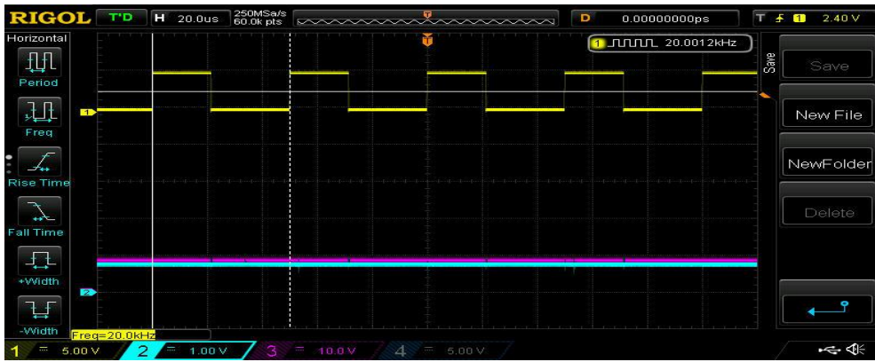
Figure. 4. 19 : Signaux de la tension de sortie et la commande MLI pour R = 75\Omega et V_r = 6.8V .
