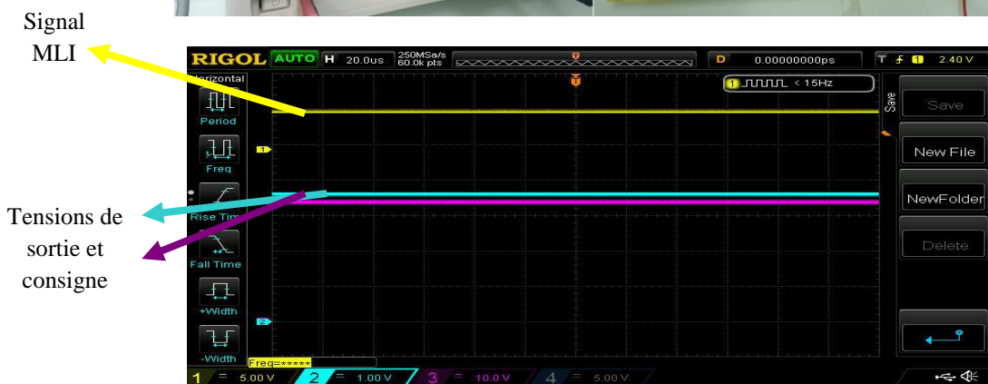
Figure. 4. 18 : Signaux de la tension de sortie et la commande MLI pour R = 50\Omega et V_r = 34.5V .
