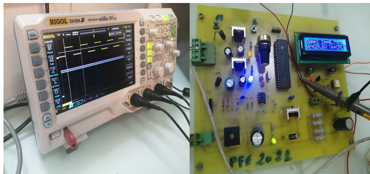
Figure 4. 25: Signaux de la tension de sortie et la commande MLI pour R = 150\Omega et V_r = 18.7V .
