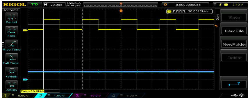
Figure 4. 23: Signaux de la tension de sortie et la commande MLI pour R = 150\Omega et V_r = 6.8V .
