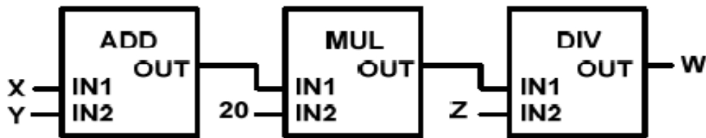
Fig.(II.7): exemple d'un programme en Fonction Bloc
