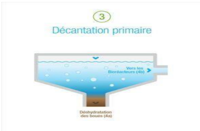
Figure N°2 : réservoir décantation primaire
