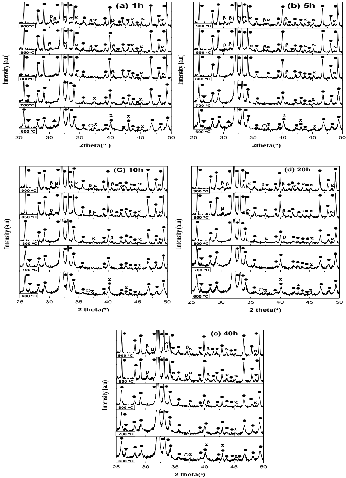
الشكل 14-1.VI: أنماط DRX لمزيج من الفوسفات الطبيعي / مسحوق الألمنيوم بعد 1h: (a)، 5h: (b)، 10h: (c)، 20h: (d) و 40h: (e) من السحق ، عند مختلف درجات الحرارة : (●: هيدروكسيباتيت، ○: CaO، α: α-TCP، β: β-TCP، χ: χ-Al 2 O 3 ، κ: κ-Al 2 O 3 ، ▲: دولوميت، ▼: كوارتز ).
