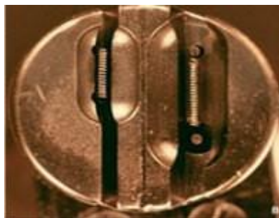
Figure1-6 :cathode constituée deux filaments de la taille différente
