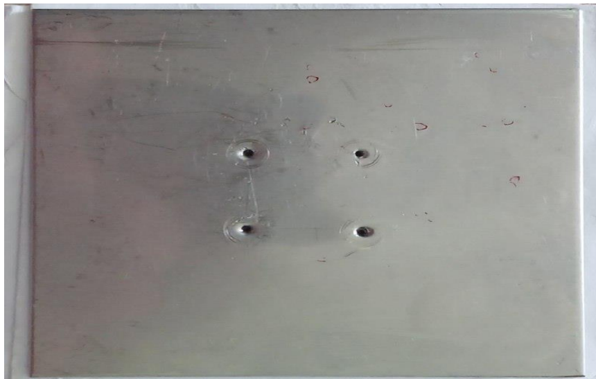
Figure 3.3 : plaque d'aluminium avec quatre trous de différentes épaisseurs
