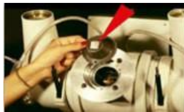
Figure 1-13 : filtration additionnelle pour la radioprotection de patient que pour la qualité de l'image.
