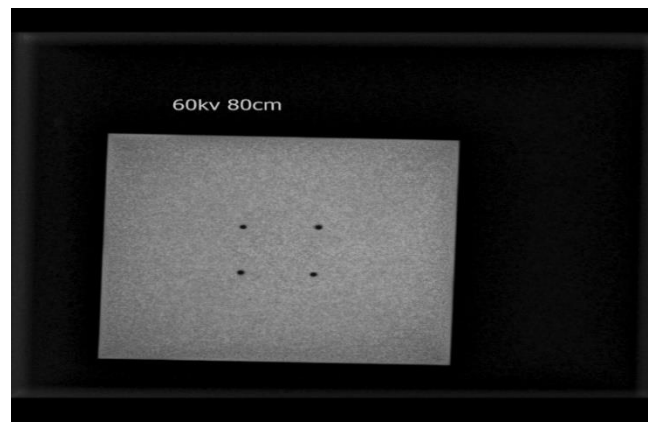
Figure3.4 : image radiographique d'une plaque d'aluminium percée à des trous de différente taille (60KV ;80cm)
