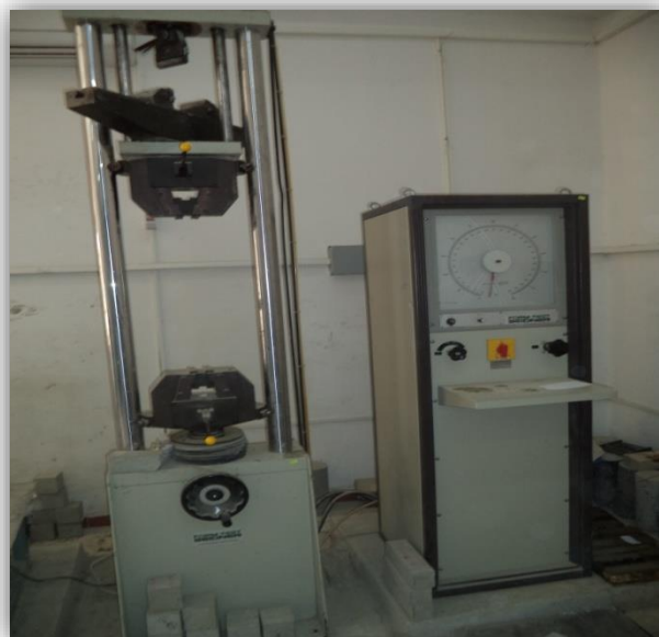
Figure -II-10 : Mesure de la résistance à la traction par flexion
