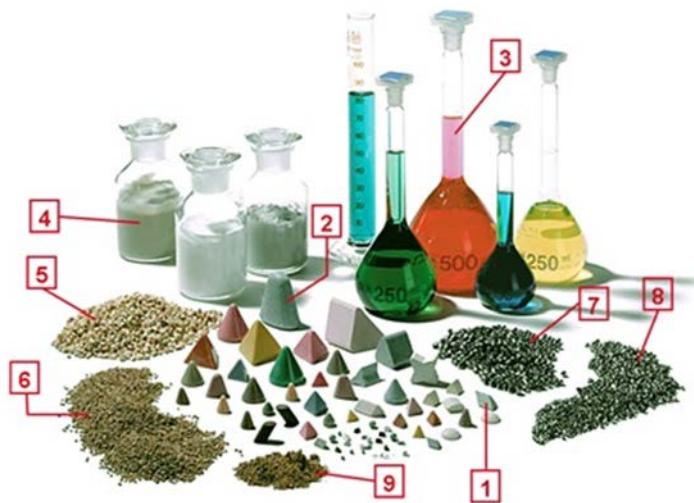
1 MMF à base de céramique 3 composés en liquide 5 6 9 MMF végétale 2 MMF à base de polymère 4 composés en poudre 7 8 MMF métallique
