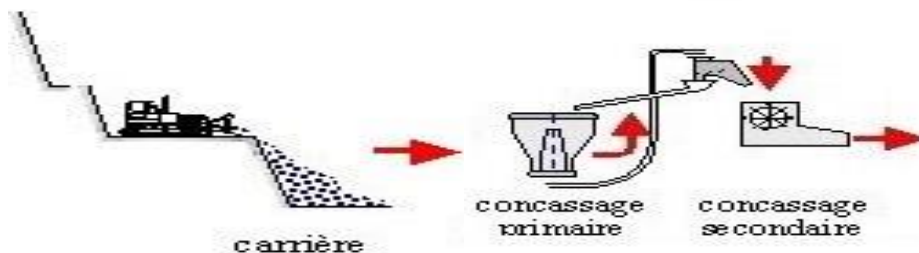
Fig 4.2 : Extraction et préparation des matières premières [23]
