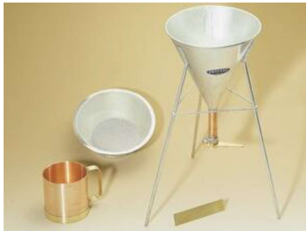
Figure 3-1 : Matériels de l'essai de la masse volumique apparente
