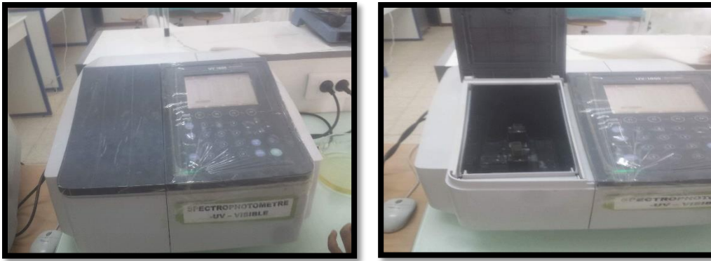
Figure 05 : la lecture de la DO à 528nm Pour la lecture à l'aide de spectrophotomètre.
