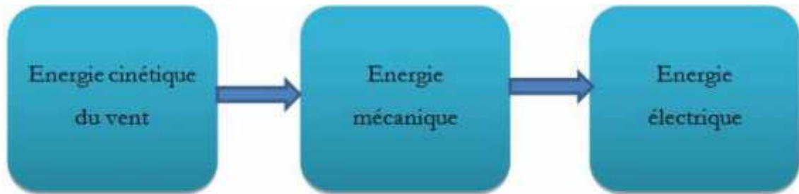
Figure 1. 4 : Conversion de l'énergie cinétique du vent
