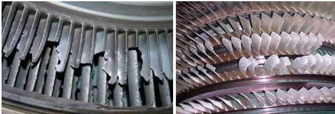
Figure I.14: conséquence d'un balourd sur un rotor d'une turbine
