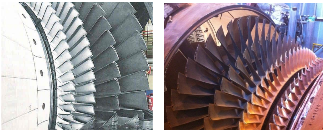
Figure I.7: Les 4 étages mobiles de la turbine
