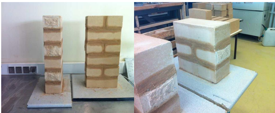
Figure IV-11:Maçonnerie en bloc de terre comprimée.
