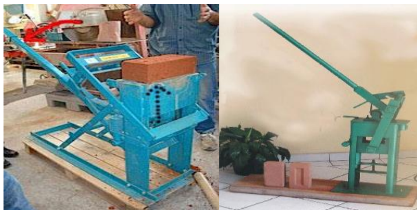
Figure IV-7: Brique de terre compressée réalisée à l'aide d'une presse manuelle
