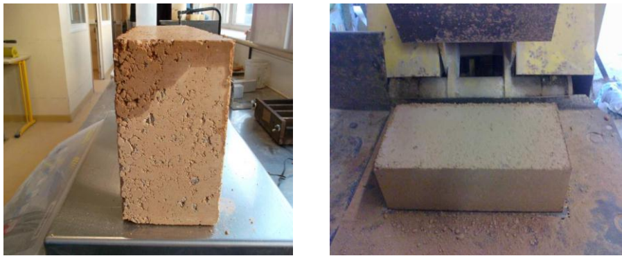
Figure IV-6: Blocs de Terre Comprimée.
