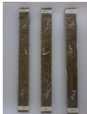
الشكل 12.III : اختبار الشد لعينات المادة المركبة المحضرة .
