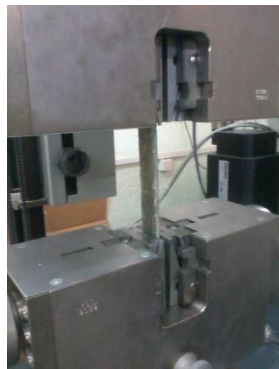
الشكل 12.III : اختبار الشد لعينات المادة المركبة المحضرة .
