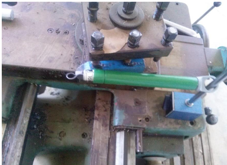
Figure IV-8 : dispositif d'étalonnage du tambour
