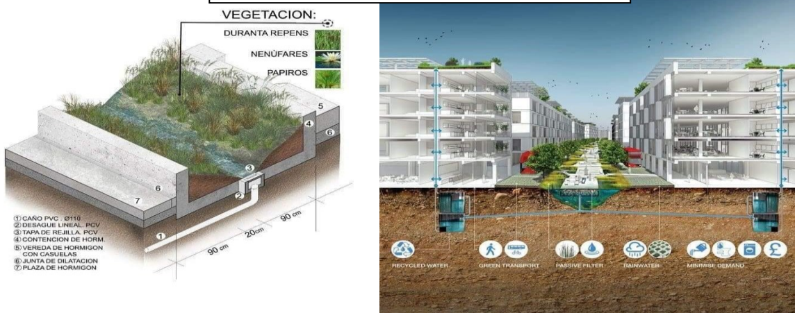
صورة رقم 19: نظام تصريف مياه الأمطار
