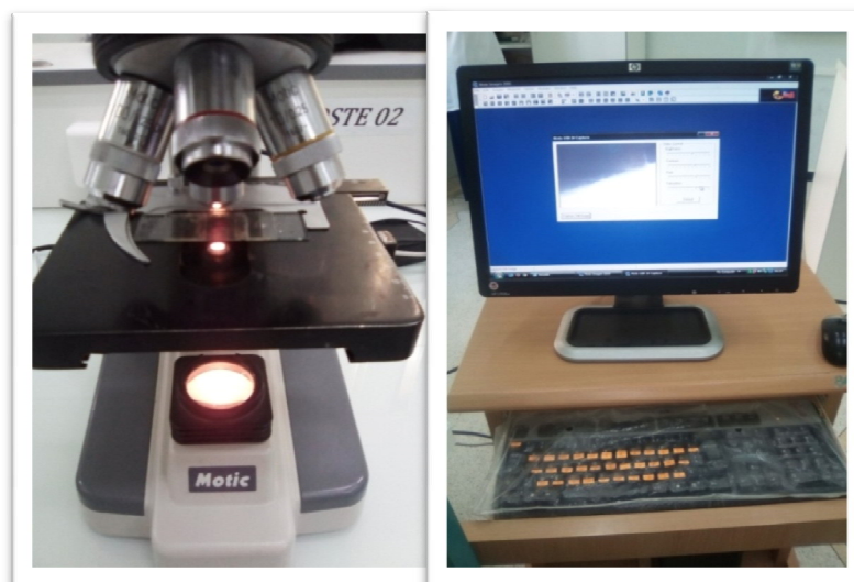
Figure 7 : Système d'observations composé d'un microscope photonique équipé d'un appareil photographique numérique relié à un ordinateur.
