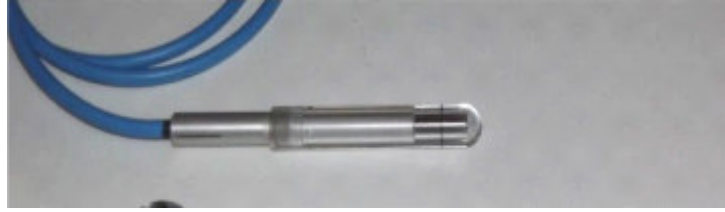
FIG. 2-13 – La chambre cylindrique [13].
