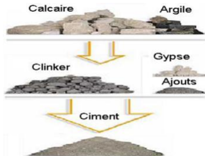
FIGURE II. 1: SCHEMA D'OBTENTION DU CIMENT
