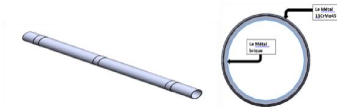
FIGURE III. 11: DIMENSIONS SIMPLIFIÉES DU FOUR UTILISÉES DANS L'ANALYSE
