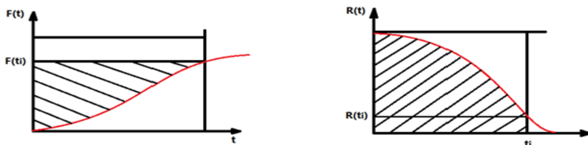
Figure III.4 : Courbe de fiabilité et fonction de répartition
