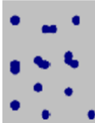
Figure I.9 : Schéma qui représente la coalescence des couches minces.
