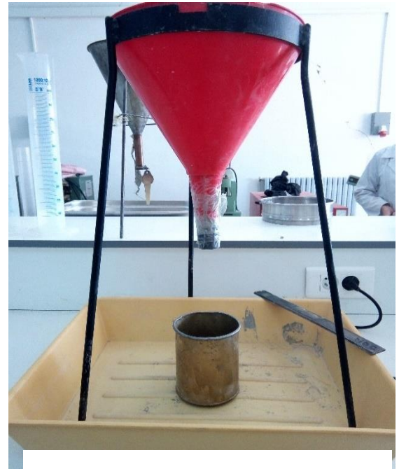
Figure 3.10 : Méthode de mesure de la masse volumique apparente
