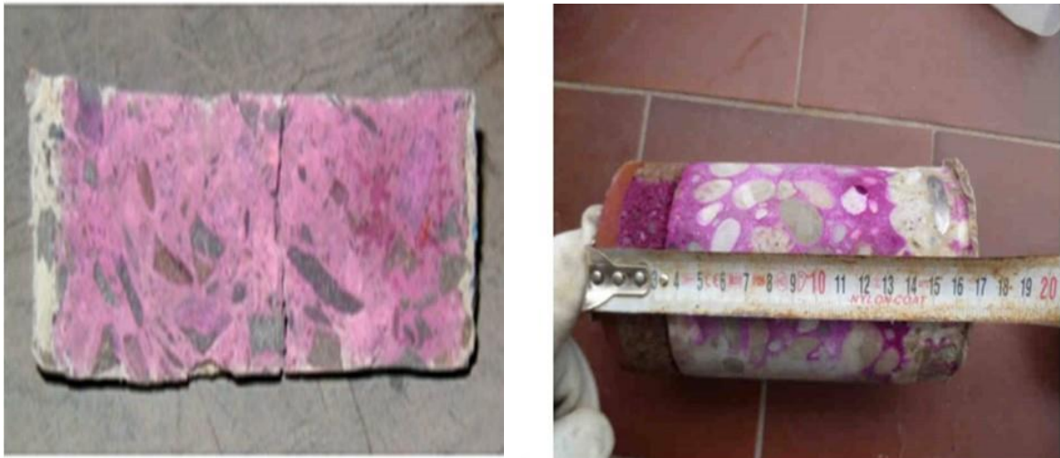
Figure 1.16: phénomène de la carbonatation. (IHAB, 2015/2016).
