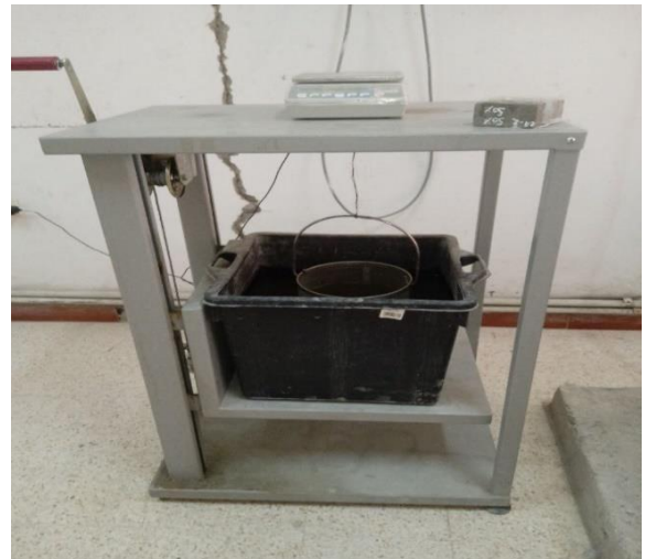
Figure II 20 : La pesé hydrostatique saturé et sous l'eau
