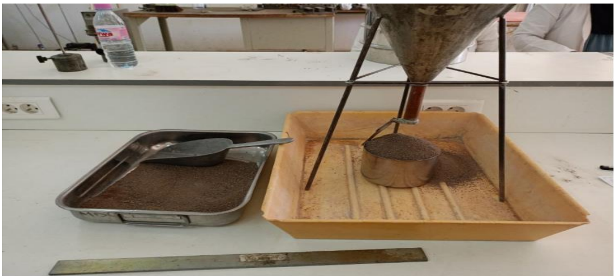
Figure II.7: Essai de la masse volumique apparente.
