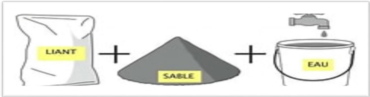
Figure I.2: Composition d'un mortier. [1]
