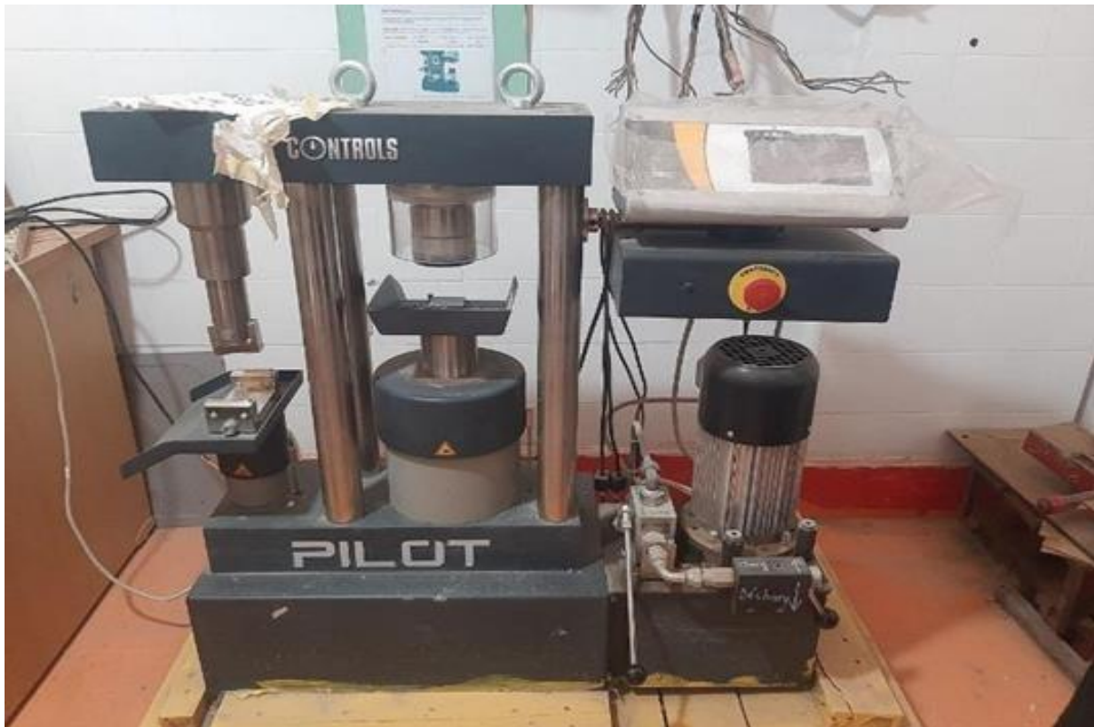
Figure II.19: L'essai de compression et de flexion par traction.
