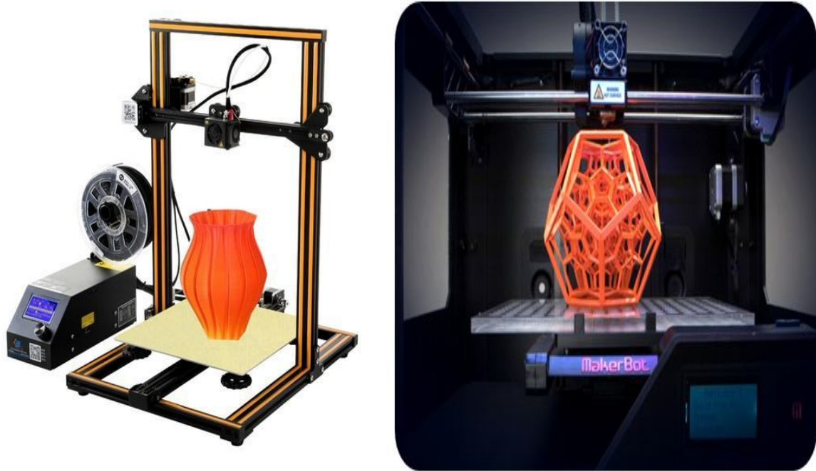
Figure.I.4: Imprimante 3D avec technologie Fused Deposition Modeling (FDM).
