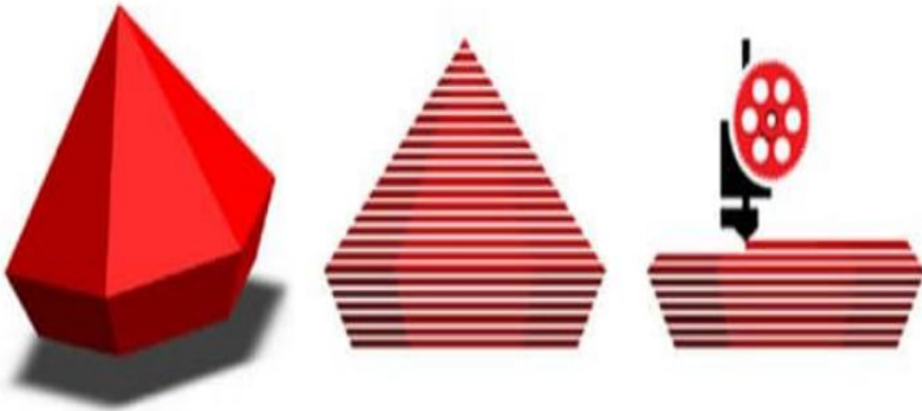
Figure.IV.29: Tranchage de forme 3D.
